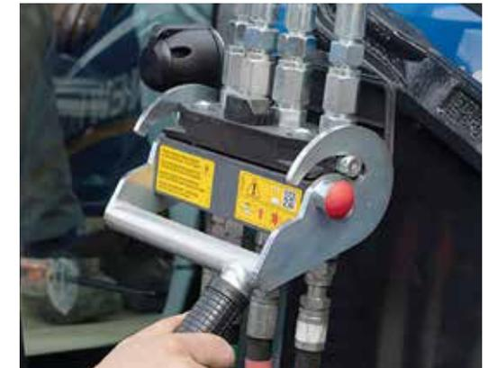
**2** Con Hydro-Fix tutti i tubi idraulici possono essere collegati al trattore simultaneamente. Il caricatore frontale viene sollevato leggermente per fissare il perno di bloccaggio nel gancio di blocco della guida di scorrimento.
