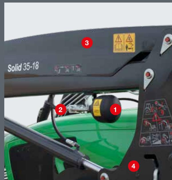
Il Comfort Drive si trova ben protetto tra il triangolo di attacco e il braccio del caricatore. E può essere attivato e disattivato mediante la valvola di arresto.
