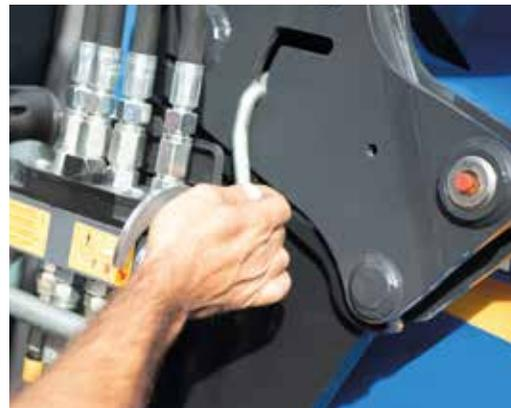
**3** Abbassando la leva di bloccaggio il caricatore frontale viene fissato saldamente all'elemento di montaggio. Per poi essere sollevato ulteriormente.
