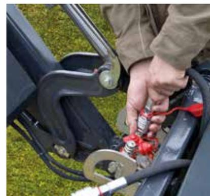
**3** Innesto del collegamento idraulico.
