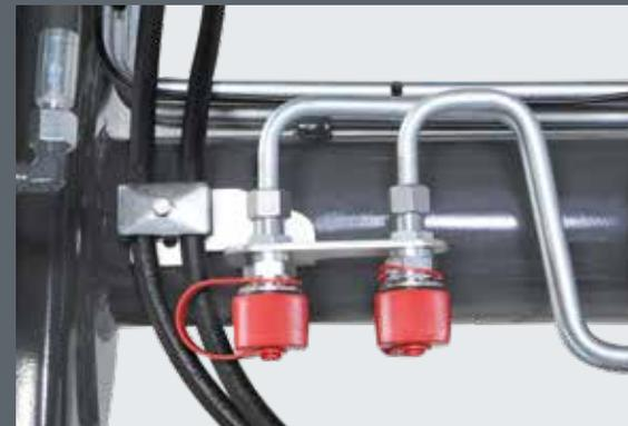
Utilizzo efficace degli attrezzi idraulici: grazie al terzo circuito di comando non servono ulteriori apparecchi di comando.
